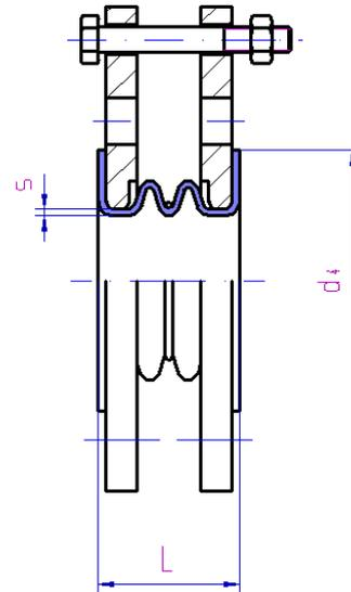
Zur Gewährleistung einer einwandfreien Montage sind unsere Kompensatoren mit 3 Begrenzungsschrauben versehen. Sie verhindern, dass der Balg im Betrieb überstreckt werden kann.
